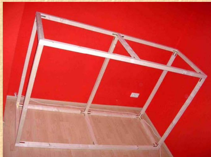
Das Grundgerüst aus 44mm Kanthölzern.
