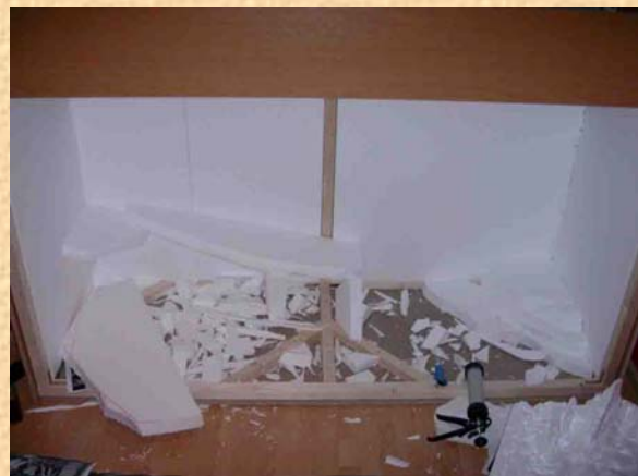
... und Vorsprünge erstellt und mit Silikon eingeklebt.
