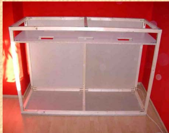
Die Rückwände werden an das Gerüst geschraubt.
