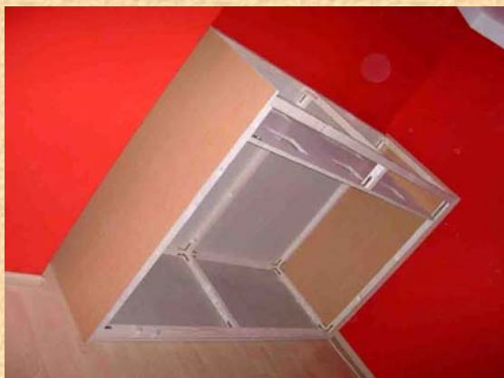
Die Seitenteile werden von Innen verschraubt ...
