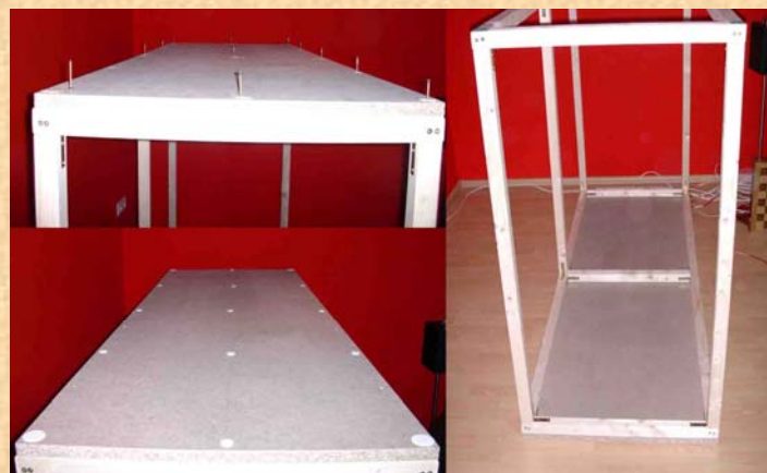
Die Bodenplatte wird mit Spackschrauben unter das Gerüst geschraubt.
